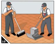
Para mejor penetración de la arena en las juntas, se puede vibrar nuevamente la superficie adoquinada.
