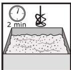
Mezcle manualmente hasta obtener una consistencia uniforme, o durante dos minutos a baja revolución (500 rpm) si es con equipo mecánico.
